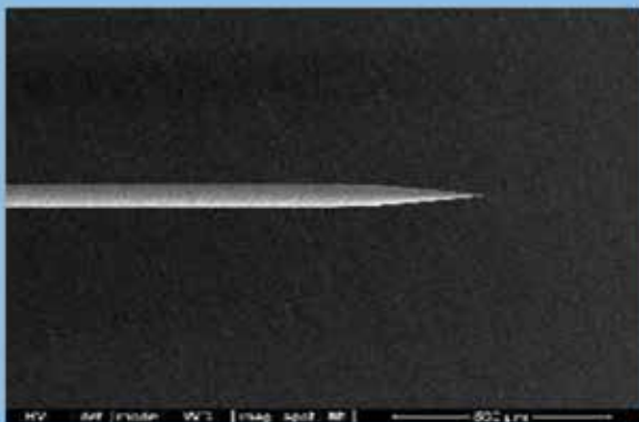
OcuRF ニードルの拡大画像 (残留粒子のリスクなし)
